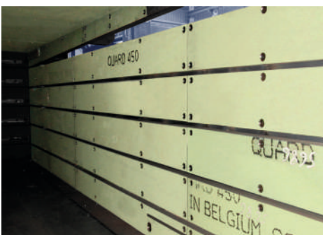
450 hardened wear liners in compaction tunnel 450 de garnituri de uzură întărite în tuneluri de compactare
