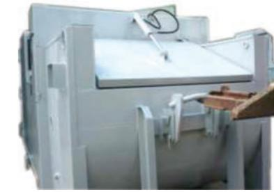
Capacul electro-hidraulic are rolul de a vă proteja în măsură de 100% față de încărcătura periculoasă.
