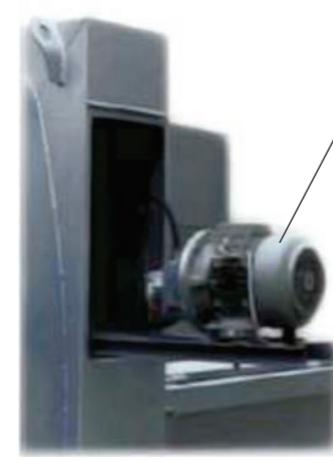
Accesul ușor datorită poziționării acestora pe şine culisante.
