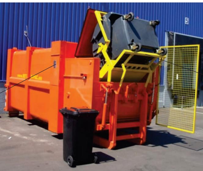
Pentru acest model ca de altfel pentru toate tipurile de prescontainere se poate opta pentru echiparea cu încărcător hidraulic integrat.
